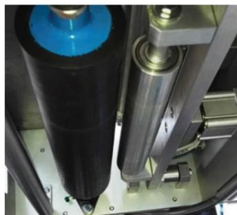
**Rullo servoassistito per tensionamento automatico della pellicola**
